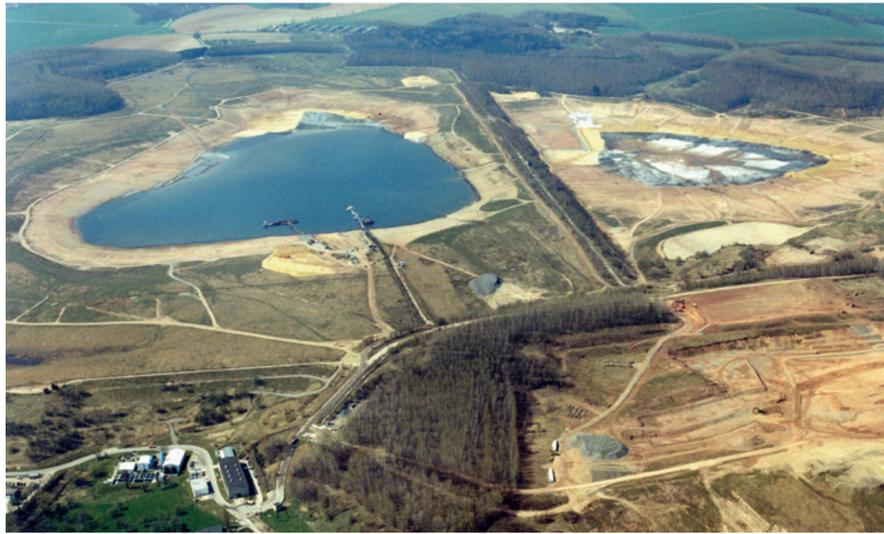
Im Tagebau von Culmitzsch wurden einst 15 bis 18 Millionen Tonnen Uranerz abgebaut und daraus 9.216 Tonnen reines Uran gewonnen. Millionen Tonnen radioaktive Rückstände wurden anschließend in die alten Grube eingespült und sedimentiert.
